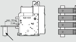
Суппорты для шин должны быть выполнены из изоляционных материалов, соответствовать чертежу и указанным размерам. В случае возникновения короткого замыкания отсутствие данного суппорта может привести к ухудшению рабочих характеристик автоматического выключателя.
