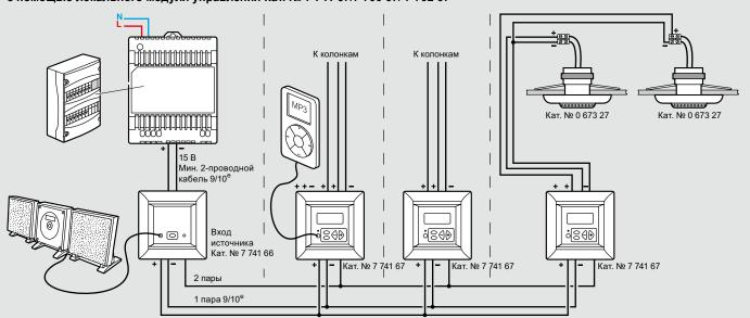
Трансляция звука из центрального источника, вспомогательного источника (MP3-плеера) или автономного FM-радиоприемника с помощью локального модуля управления Кат. № 7 741 67/7 700 67/7 702 67 и FM-тюнера Кат. № 7 741 68/7 700 68/ 7 702 68
