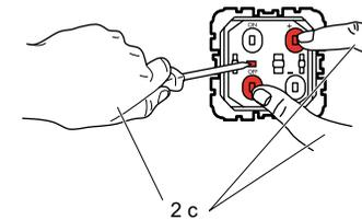
**Включение на предустановленных уровнях + работа в режиме постепенного гашения света**
